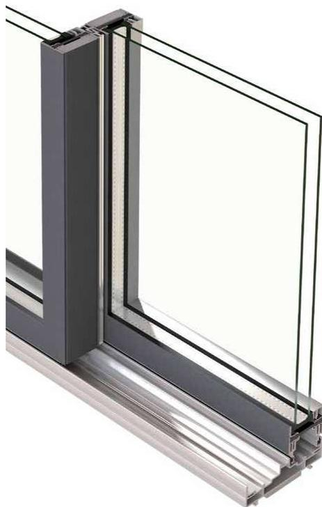
Puerta Corredera de 2 hojas, sistema JANSEN de la serie **JANISOL ARTE** formado por perfiles de acero de calidad S235JRG2 según la EN10025:1993 laminados, de 1,5 mm de espesor y 60 mm de profundidad en marco y hoja y tratamiento Sendzimir (zincado en caliente).
